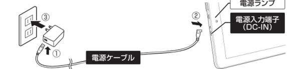
発熱や故障、もしくは本機の性能低下の原因になりますので、本機への給電は、必ず付属のACアダプターおよび電源ケーブルを使用して、電源入力端子(DC-IN、兼microUSBポート)からおこなってください。電源ケーブルの延長はおこなわないでください。(上の図で指定する以外の接続はしないでください。)
