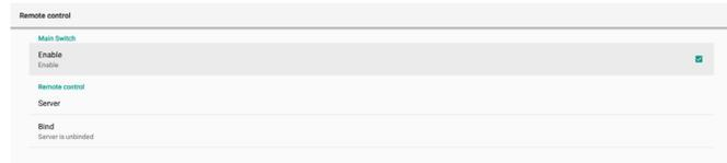
「Enable(有効)」チェックボックスをクリックして、リモートコントロールクライアントサービスを有効または無効にします。デフォルト設定は「Enabled(有効)」です。リモートコントロール機能を使用するには、デバイスがリモートコントロールサーバーにバインドされている必要があります。
