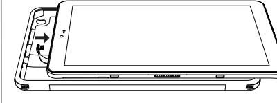
タブレットの、コネクターを挿入した側面をジャケットの縁の内側に押し込みます。
