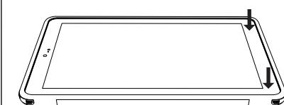
反対側の両角を縁の内側に押し込みます。周囲が縁の内側に納まれば装着完了です。
