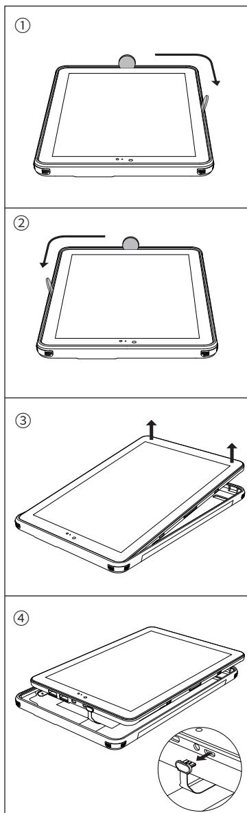
① 本機からタブレットを取り外すときは、ギターのピックのような、樹脂でできた薄いへら状のものを用意して、タブレットのスピーカー開口部側の中央付近に差し込みます。差し込んだら外周に沿って右側に動かすとタブレットが本機から浮きます。
