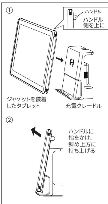
① 本機後部のハンドルを上にして、背面の接点充電端子と充電クレードルの接点充電端子の位置が概ね合うように近づけると、磁力で引きよせられ接合が完了します。接合が完了すると、充電が開始され、充電クレードルの電源ランプの色が青色に変わります。マグネットの磁力で接合状態を保ちます。
