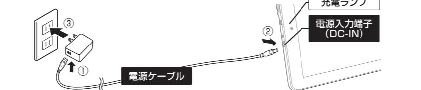
本機への給電は、必ず付属のACアダプターおよび電源ケーブルを使用して、電源入力端子(DC-IN)からおこなってください。(上の図に指定する以外の接続はしないでください)。発熱や故障の原因になりますので、付属のACアダプターから本機の電源入力端子までの経路にUSBハブを使用しないでください。また、ケーブルの延長やコネクタ変換機器の接続をしないでください。
